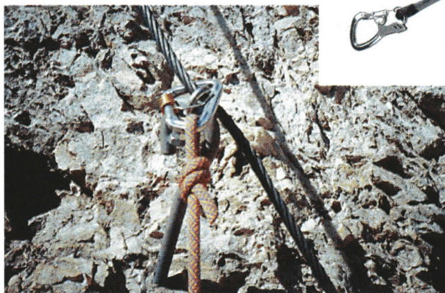
Sopra: Il dissipatore tipo "a Y", l'unico accettato dalla UIAA.
