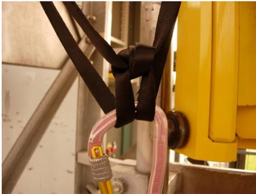
In questo tipo di sosta, l'abbassamento del vertice dovrebbe essere minimo (dovuto essenzialmente alla strizione del nodo).
