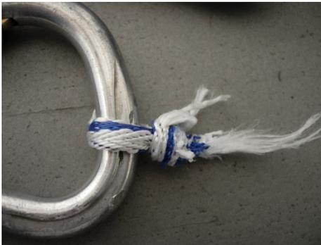
Il moschettone del vertice della sosta va ad impattare contro il nodo del ramo dalla parte dell'ancoraggio che salta.
